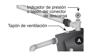
c. Asegúrese de que el nivel del agua en la cavidad de la bomba (A) sea constante. Si el nivel del agua baja, podría haber una fuga en la válvula de pie. Revise la válvula o el tubo de succión. Si el nivel de agua se mantiene constante, cubra el indicador de presión o el tapón del conector de descarga y las roscas del tapón de ventilación con cinta para roscas y enrósquelos en la bomba (A). Apriete con una llave de tuercas (no se incluye).
